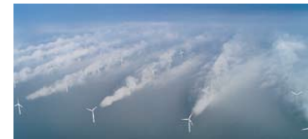
Parc d'éoliennes offshore de Horns Rev au Danemark révélant l'interaction de leurs sillages sur les éoliennes aval (80 éoliennes, diamètres des rotors 80m).
